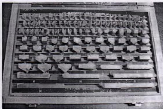
4.6 –rasm. uzunlikning chekka o'lchovlari to'plami (Majmua KMД №3, aniqlik sinfi - 0,1,2,3; po'lat)
