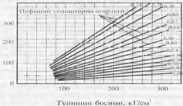
II.3.2-расм. Турли босимларда газнинг нефтда эрувчанлик чизиклари.
